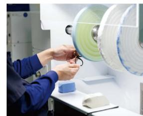
「研磨」の工程では、職人の手によって部品が細部まで磨かれる。独自のノウハウにより部品一つ一つに輝きが宿る
